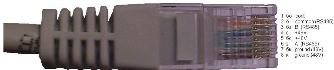
Рисунок 1 – Нумерация и обозначение контактов (обжим витой пары по стандарту EIA/TIA-568B)
