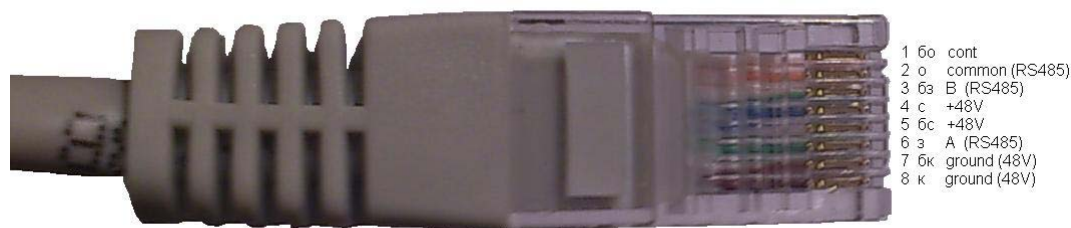
Рисунок 1 – Нумерация и обозначение контактов (стандарт EIA/TIA-568B)
