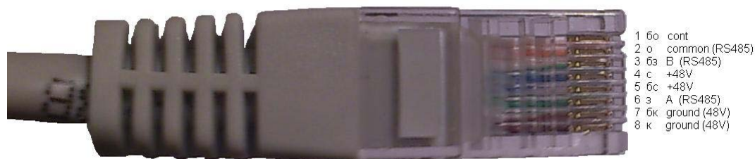
Рисунок 1 – Нумерация и обозначение контактов вилки (обжим витой пары по стандарту EIA/TIA-568B)
