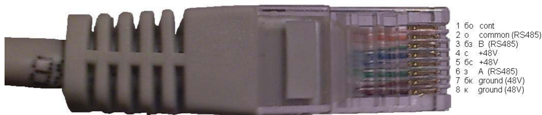
Рисунок 2 – Нумерация и обозначение контактов вилки (обжим витой пары по стандарту EIA/TIA-568B)
