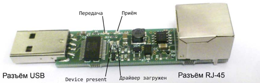
Рисунок 1 – Расположение индикаторов и разъёмов
